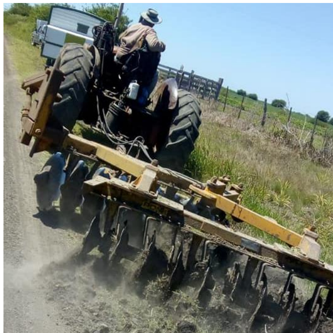
Ilustración 4: Rome. Incrementa exponencialmente la eficiencia de la niveladora en suelos vertisoles, y mejora sustancialmente el trabajo de abovedado, ya que al generar “tierra desterronada” se puede mover más m 3 de tierra y lograr un mejor trabajo, evitando los “pencones” de tierra sacados por la hoja niveladora y que no ayudan al trabajo de abovedado del camino.
